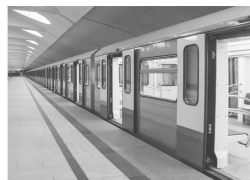
图2 用不锈钢制造的地铁列车的车体
