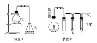
将一定量的苯和溴放在烧瓶中,同时加入少量铁屑,3~5 min 后发现盛有 AgNO<sub>3</sub> 溶液的锥形 瓶中有浅黄色的沉淀生成。
