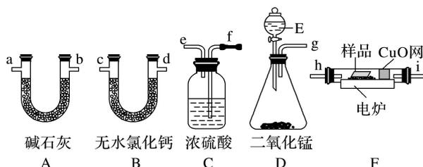
现准确称取 1.8 g 样品(只含 C、H、O 三种元素中的两种或三种)，经燃烧后 A 管增重 1.76 g，B 管增重 0.36 g。请回答：
